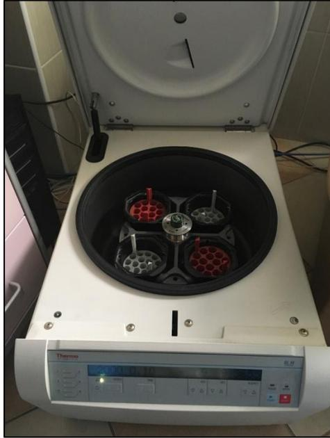
**Рис. 66. Центрифуга для отделения форменных элементов и их фрагментов.**
